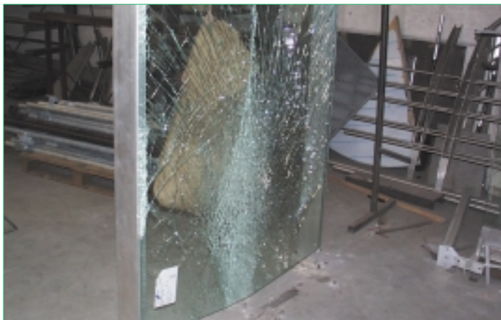
Afin de satisfaire à la norme STS 54, un test dynamique a eu lieu: un sac de sable de 50 kg a été catapulté d'une distance de 3 m sur la plaque en verre.
